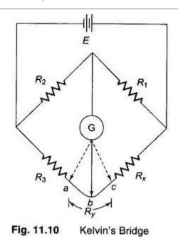
$\frac{R_{cb}}{R_{ab}} = \frac{R_{\rm i}}{R_{\rm 2}} \tag{11.6}$
