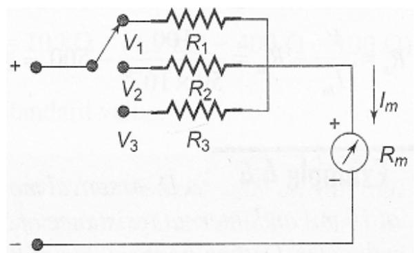
fig 4.2 Multirange Voltmeter
