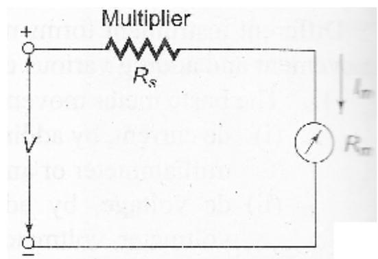
fig 4.1 Basic Voltmeter
