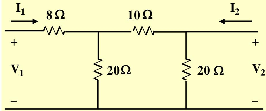
$$\begin{bmatrix} V_1 \\ V_2 \end{bmatrix} = \begin{bmatrix} 20 & 8 \\ 8 & 12 \end{bmatrix} \begin{bmatrix} I_1 \\ I_2 \end{bmatrix}$$
